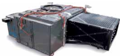
La boucle diphasique ou caloduc de EHP qui s'installe pour récupérer la chaleur sous la voiture du métro.
